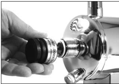
Step 4 - Remove Gland Nuts
